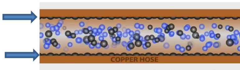
Fig6 : L'huile s'accumule sur la périphérie sous forme de film d'huile. Les tubes rainurés créent plus de points de rugosités augmentant les dépôts d'huile.
